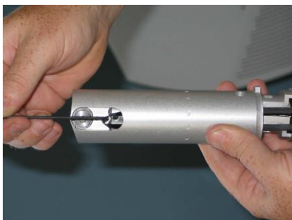
Imagen 12. Placing the flat belt
