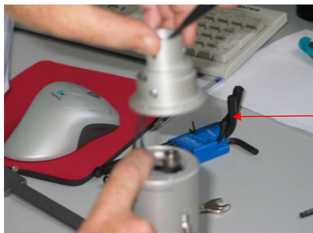
Imagen 5. Disassembling the DRT
